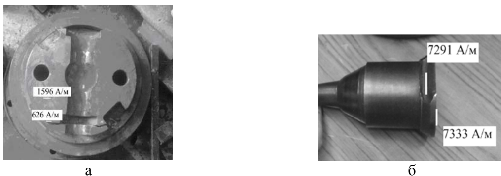
Рис. 6. Значения коэрцитивной силы в рабочих деталях штампов для ГОШ, пришедших в предельное состояние по критерию роста трещин:
