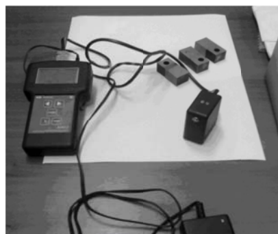
Рис. 2. Измерение коэрцитивной силы вблизи зоны разрушения в образцах СТ-1 из стали Х12МФ после испытания их на трещиностойкость
